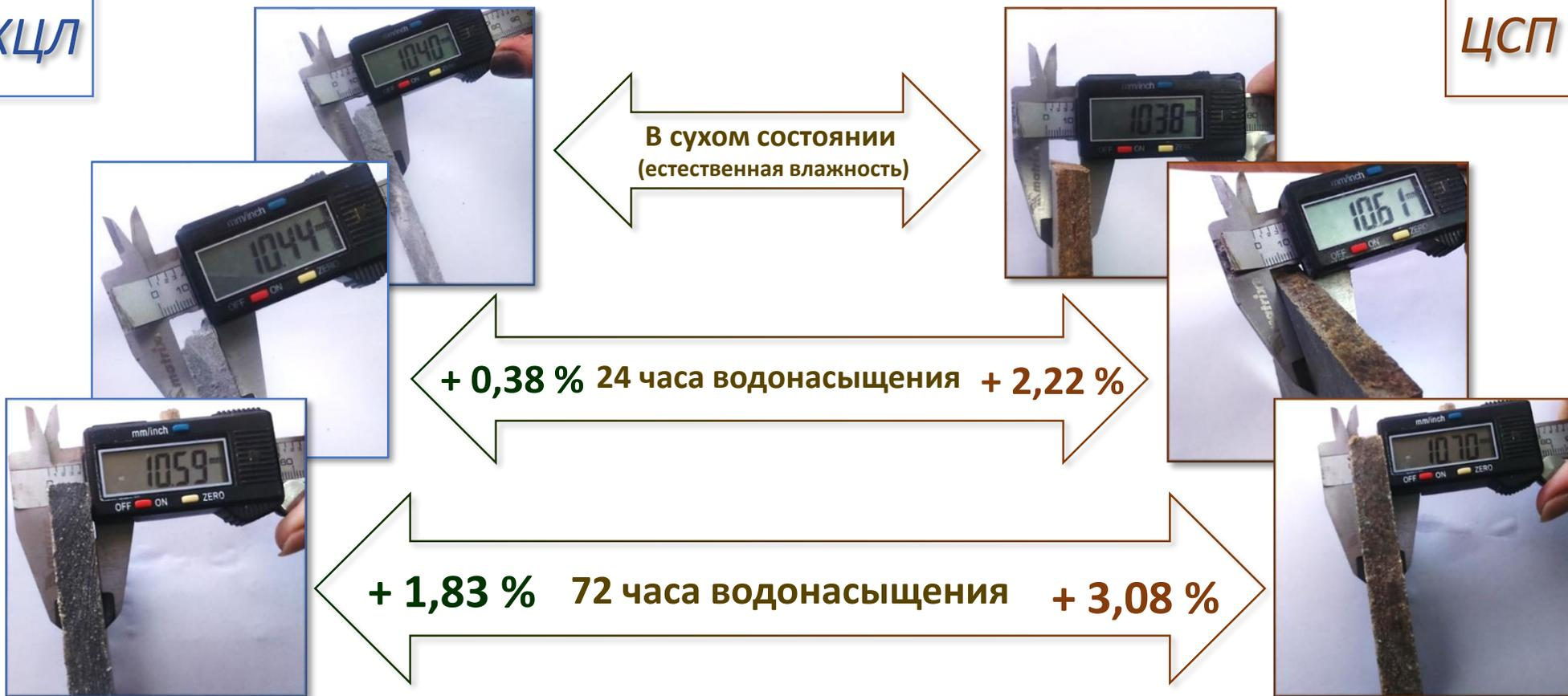
**Вывод:** изменение геометрических параметров при водонасыщении (разбухании) у **ХЦЛ** происходит в меньшей степени, чем у **ЦСП**. Такое воздействие влаги совместно с перепадами температур (заморозка/разморозка) с каждым новым циклом постепенно разрушает материал и снижает его прочность. Лист **ХЦЛ** более стоек к таким воздействиям, чем лист **ЦСП**.
